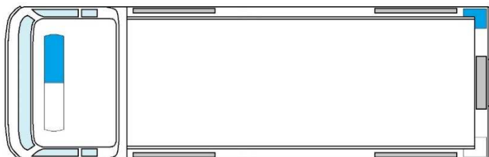
První fáze – Světelné zařízení vyzařuje světlo modré barvy na pravé straně od podélné osy ZPA ve směru jízdy.
