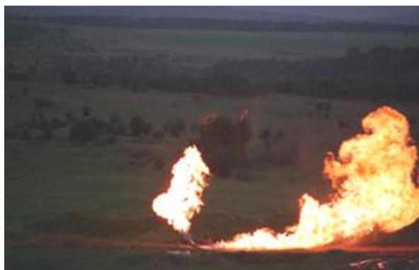
Obr.: Únik acetylenu a jeho hoření z tepelně zatížené plně tlakové lahve po několikanásobném prostřelení
