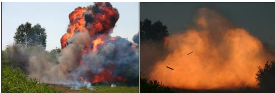
Obr.: Projev fyzikálního výbuchu lahve a shoření plynovzdušné směsi
