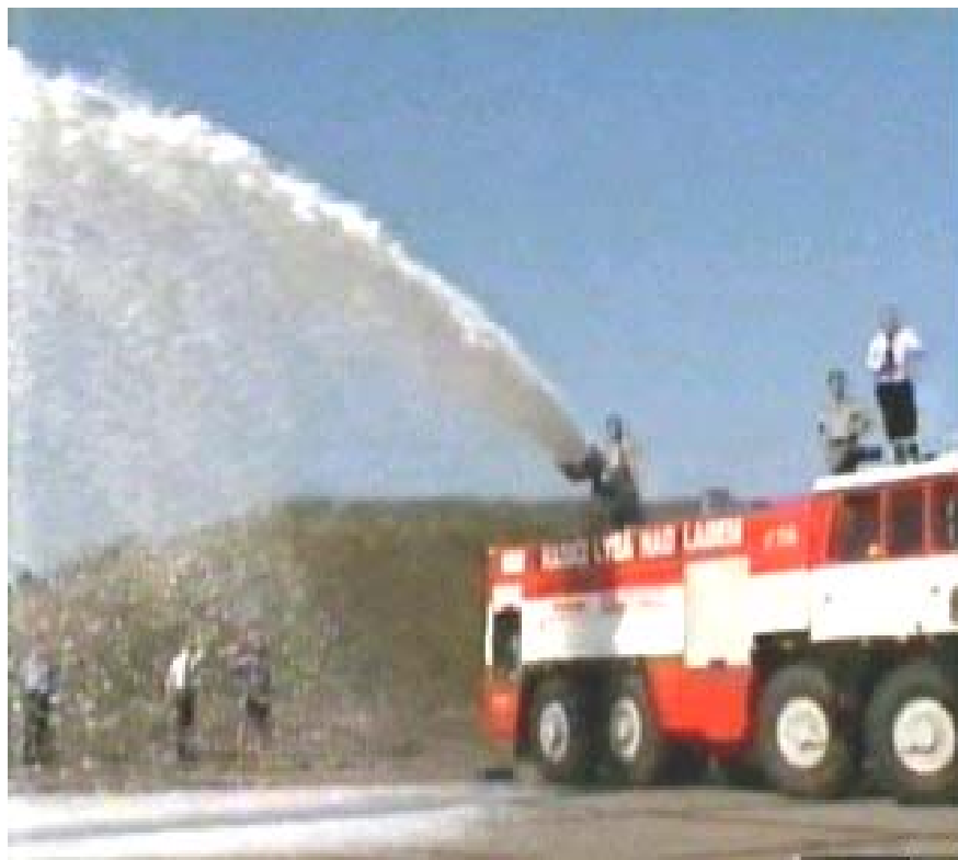
Obrázek č. 9 Aplikace střední pěny proudnicí Blizzard 2000 z lafetové proudnice na CAS
