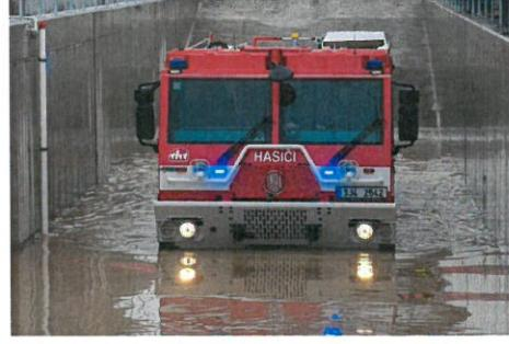
Unikátem tohoto areálu je polygon pro zkoušky jízdy v klidné vodě. Ten byl vybudován za účelem testování a zkoušek požárních automobilů a techniky, které je během zásahů používána v podmínkách jízdy ve vodě a to zejména při povodních. Polygon je dlouhý 54 metrů a hasičská auta se mohou brát až v hloubce 1,6 metrů. Díky téměř výkonnému čerpání se tento polygon naplní pouze hodinu, rychlosť: 5000 litrů za minutu.
