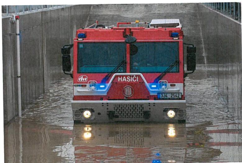
Unikátem tohoto areálu je polygon pro zkoušky jízdy v klidné vodě. Ten byl vybudován za účelem testování a zkoušek požárních automobilů a techniky, která je během zásahů používána v podmínkách jízdy ve vodě a to zejména při povodních. Polygon je dlouhý 54 metrů a hasičská auta se mohou brodit až v hloubce 1,6 metru. Díky třem výkonnému čerpadlům se tento polygon napouští pouze hodinu, rychlosť 5000 litrů za minutu.
